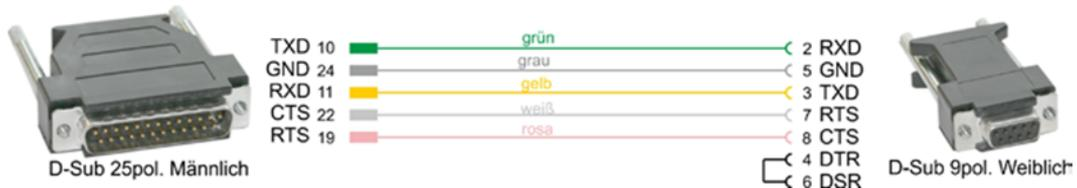
Abbildung 6: Kabel zwischen Timy und seriellen Anschluss
